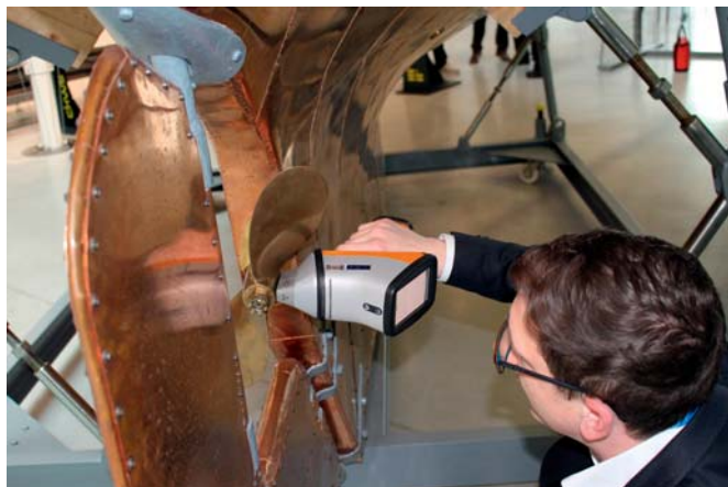
Badanie składu pierwiastkowego śruby napędowej jachtu „Dal”. Fot. Agnieszka Tomczyk (PCB Services)
