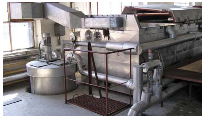
Wanna do konserwacji drewna metodą „na ciepło” w pracowni konserwatorskiej w Tczewie. Fot. Irena Rodzik
